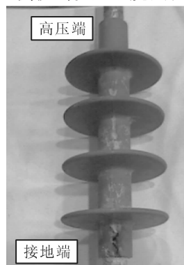
图2 经过1000 h盐雾试验的复合绝缘子
